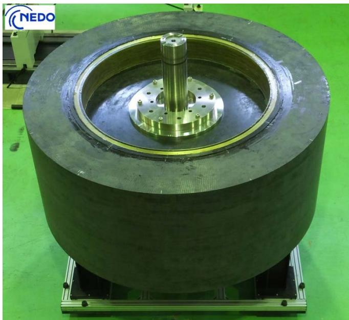
写真1 実証機用フライホイールの外観
