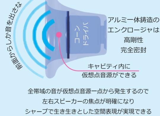
HSP01のエンクロージャ形状は、コーンユニット前方のキャビティ内に「仮想点音源」が出来るように設計されており、全ての音はその一点から出力されるように聴こえます。
